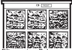
Filtro sucio – Debe ser limpiado
