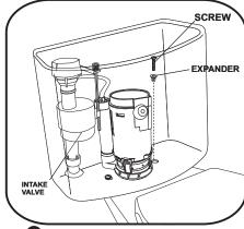
4 TIGHTEN SCREWS ALONG WITH EXPANDERS INTO TANK; SIT TANK ON BOWL.
